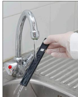
Abb. 23: Reinigung des Teststreifenhalters
