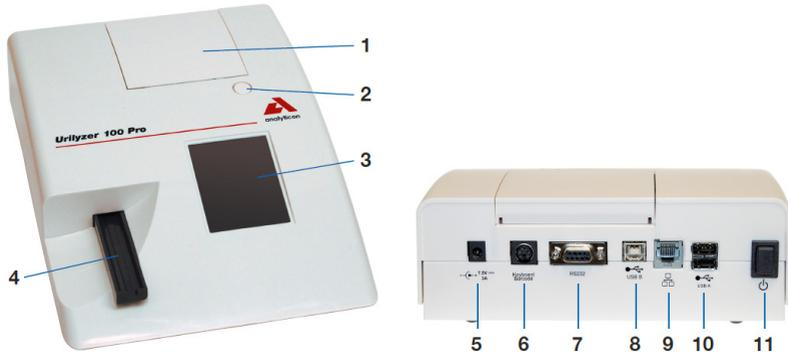
**Abb. 2:** Vorder- und Rückseite mit Beschriftung
