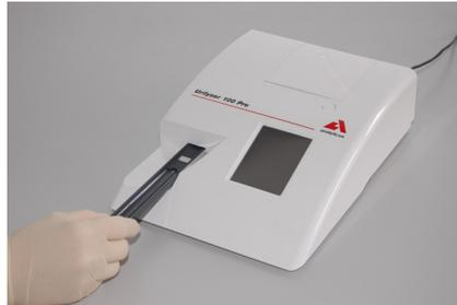
Abb. 3: Einführen des Teststreifenhalters
